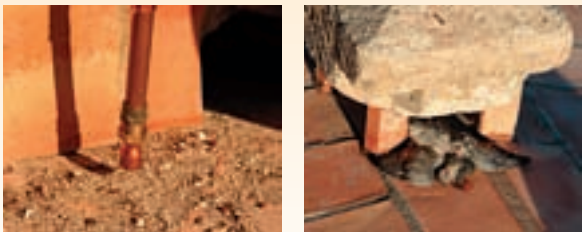
Sensor de encharcamiento a la izquierda, a su derecha podemos ver la boca del desagüe que intentamos monitorizar. A la derecha, paloma muerta en el techo de la catedral, uno de los múltiples factores que podrían atascar los desagües.
