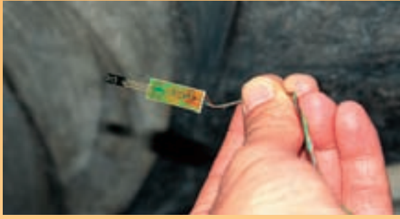
Detalle de un sensor antes de ser introducido en la pared.
