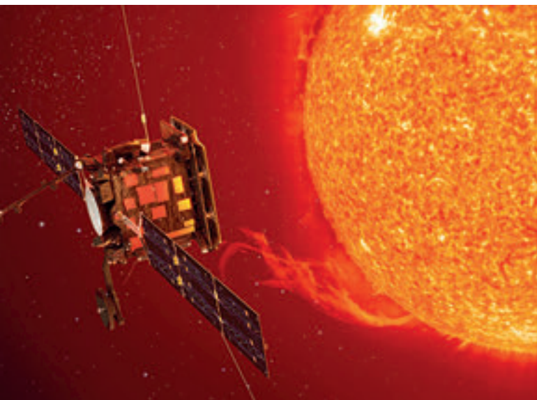
Representació artística de Solar Orbiter (no a escala), que serà llançada a l'espai a principis de 2019. S'hi pot veure l'escut calorífic que protegeix la instrumentació científica. La nau s'aproximarà al Sol fins a 42 milions de quilòmetres. En la barra posterior se situen la majoria dels instruments in situ .
