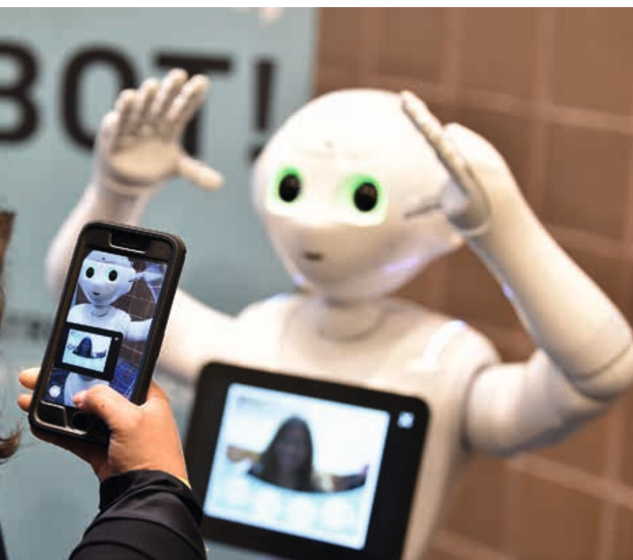
Figura 7. Els humanoides mòbils de mig cos són útils en la investigació de les interaccions entre humans i robots. Un exemple és Pepper, desenvolupat per Softbank Robotics, el principal atractiu del qual és la seua capacitat per a la interacció amb humans en diversos àmbits, des de l'educatiu fins al sector serveis, en què ha sigut utilitzat com a guia de diferents instal·lacions comercials o públiques.
