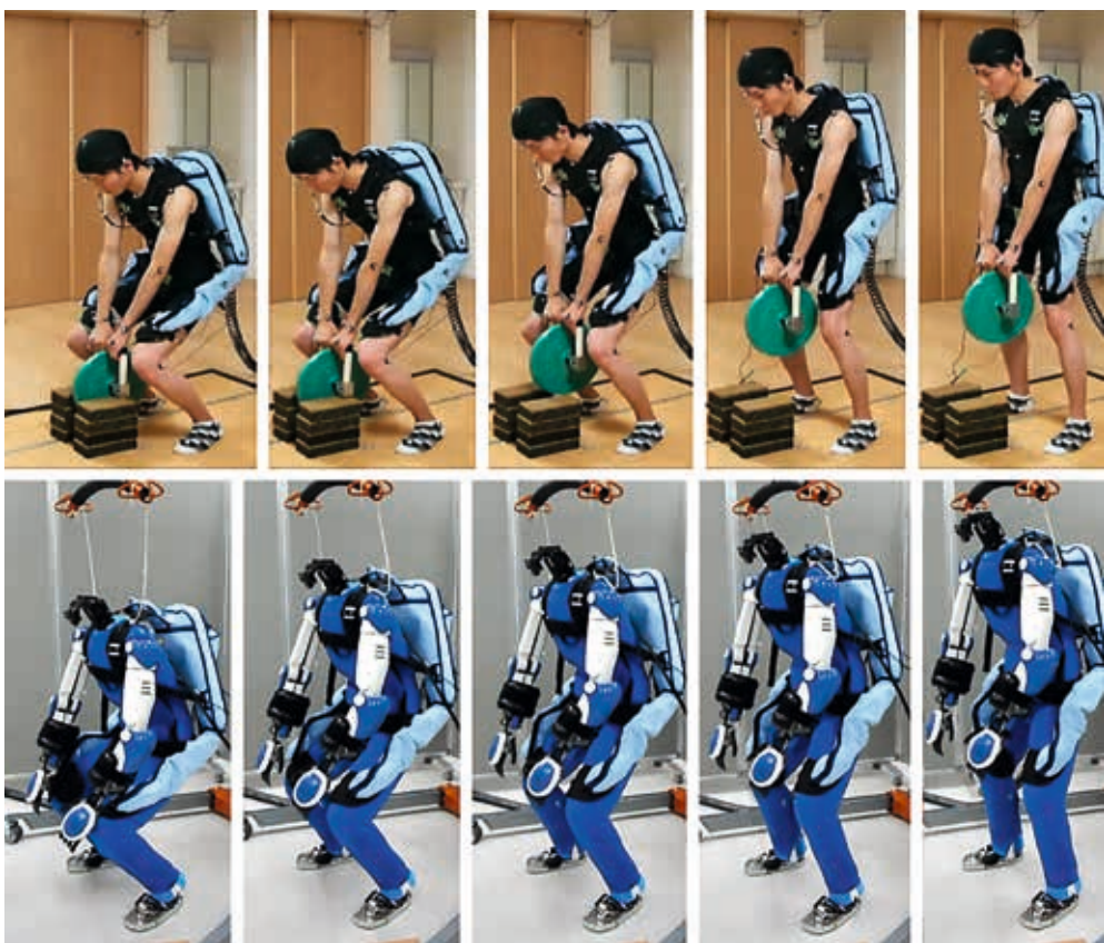
Figura 6. Els humanoides poden ser utilitzats per a avaluar dispositius portàtils, el que evita alguns problemes dels experiments realitzats amb humans, com ara l'avaluació quantitativa de l'efecte de suport en lloc de qüestionaris subjectius. En les imatges, avaluació per l'humanoide HRP-4 del muscle suit , dispositiu pneumàtic assistencial que permet a un treballador humà alçar i transportar pesos majors del que podria per si mateix.
